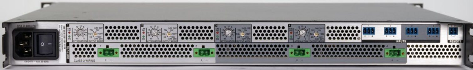
Foto 3: Auf der Rückseite des IHE-Gehäuses befinden sich die Ein- und Ausgänge mit zwei- bzw. dreipoligen Phoenix-Anschlüssen sowie die Wahlschalter für den Betriebsmodus und die Gain-Steller für die vier Kanäle.
