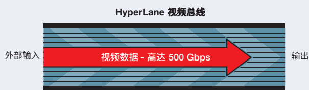
面向未来的 500 Gbps 视频总线可同时传输超过 20 路 4K/60 信号源，并支持 8K 和其它新兴的信号格式
